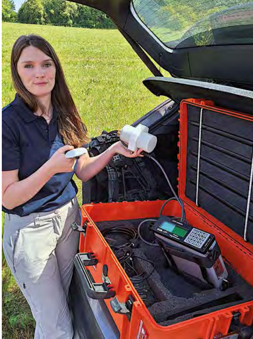
Mit Messgerät, GPS-Sender und Protonenmagnetometer machte sich die Geologin Sabine Kummer auf die Suche nach bisher unbekannten Maaren – und wurde fündig.
