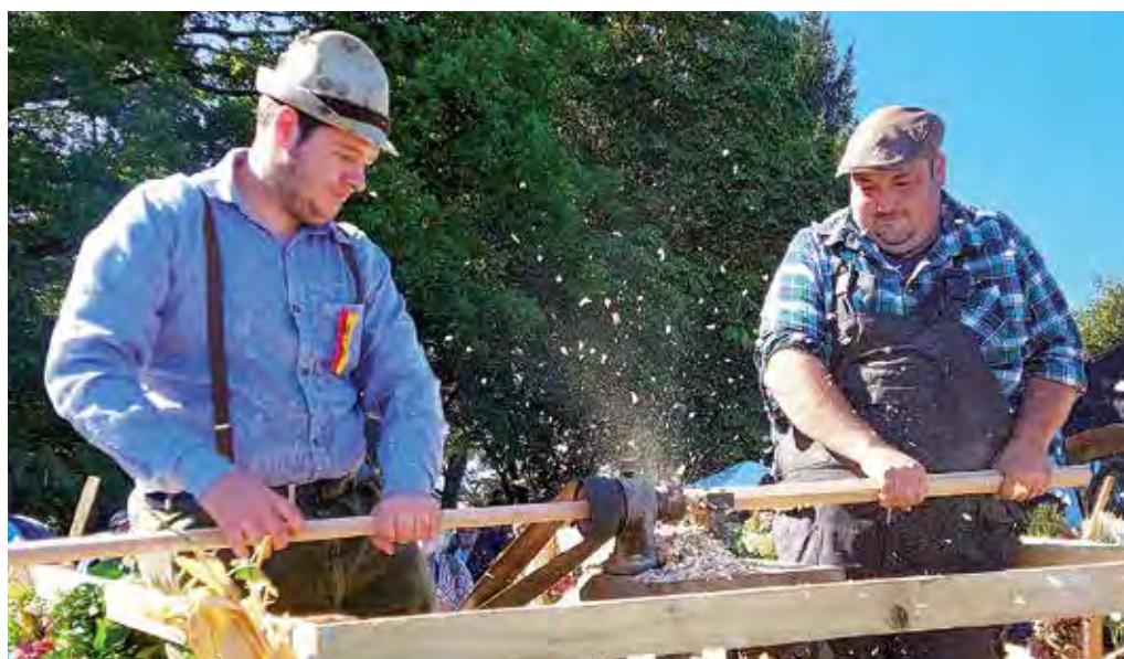
Rechts: Thomas Hansen (rechts) und Nils Oelliger drehen an der Maschine (Baujahr 1941) im Dollendorfer Zug 2023 aus Vierkanthölzern Besen- und Schaufelstiele:
